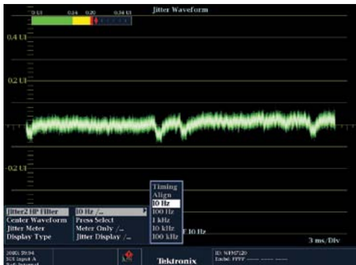
Режим измерения джиттера с фильтром 10 Гц
