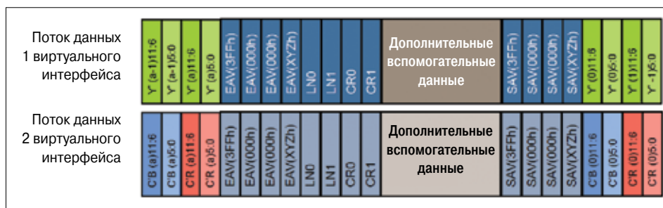
Рис. 52. Уровень А, структура преобразования 4 сигналов Y'C'bC'r
