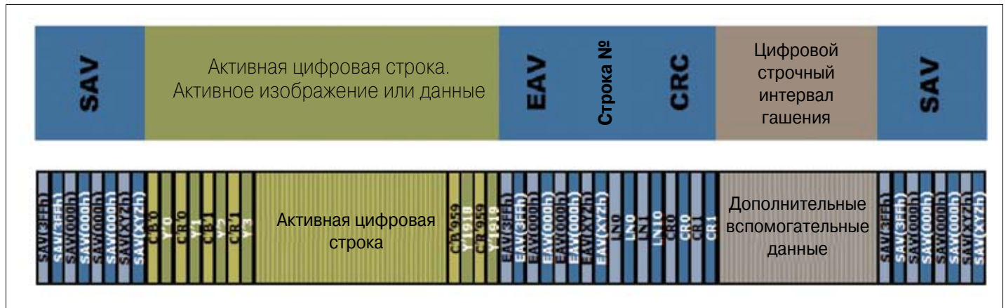
Рис. 34. Структура данных одиночной строки в последовательном цифровом интерфейсе SDI
