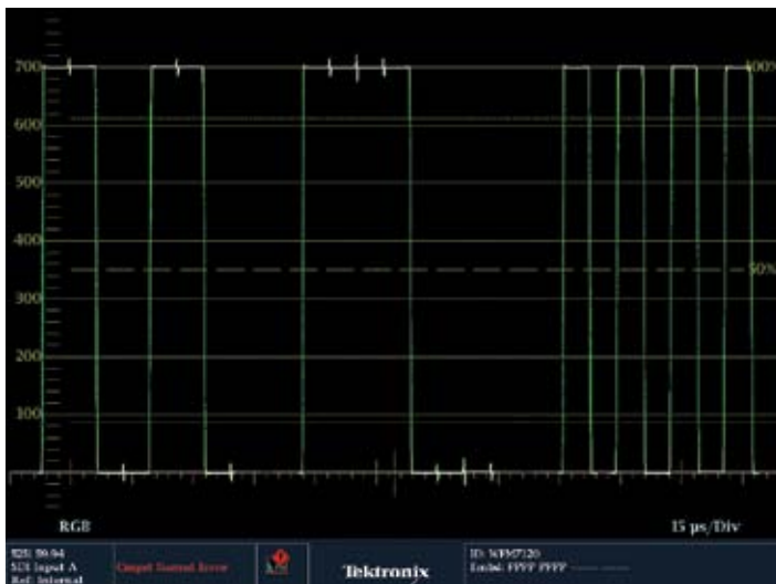
Рис. 97. Окно режима R'G'B' «Parade» («Показ») монитора WFM7120 для сигнала цветных полос с насыщенностью 100%
