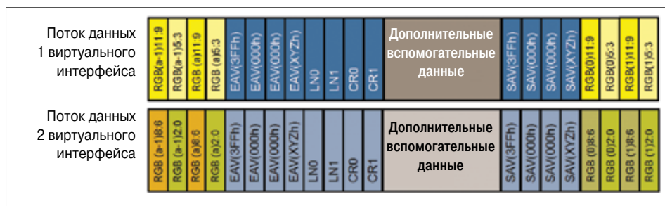
Рис. 51. Уровень А, структура преобразования 3 сигналов R'G'B'
