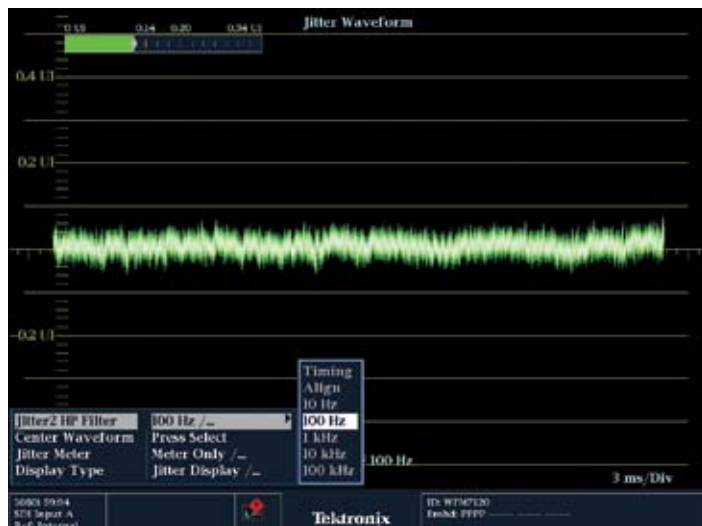
Режим измерения джиттера с фильтром 100 Гц
