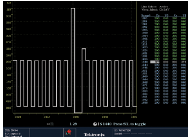
Рис. 29. Пакет опорных синхросигналов EAV (270 Мбит/с), отображаемый в виде мультиплексированных данных
