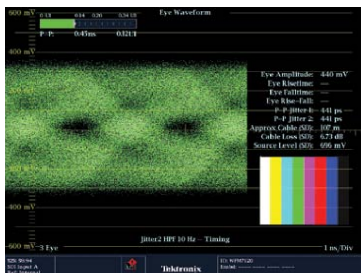
Рис. 77. Отображение на дисплее WFM7120 закрытия глаза из-за чрезмерно большой длины кабеля
