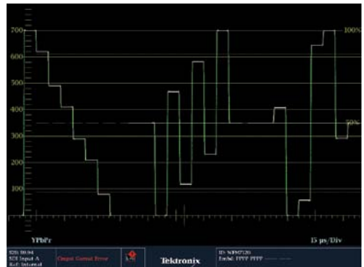
Рис. 98. Окно режима Y'/C'b/C'r монитора WFM7120 для сигнала цветных полос с насыщенностью 100%
