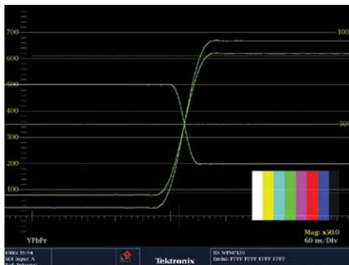
Рис. 90. Измерение межканальных временных соотношений с использованием перехода зелёный/пурпурный
