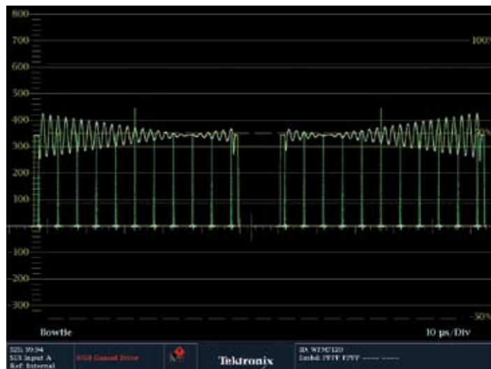
Рис. 95. Окно режима «Bowtie», сигнал Pb запаздывает на 55 нс, а сигнал Pr опережает на 50 нс сигнал Y
