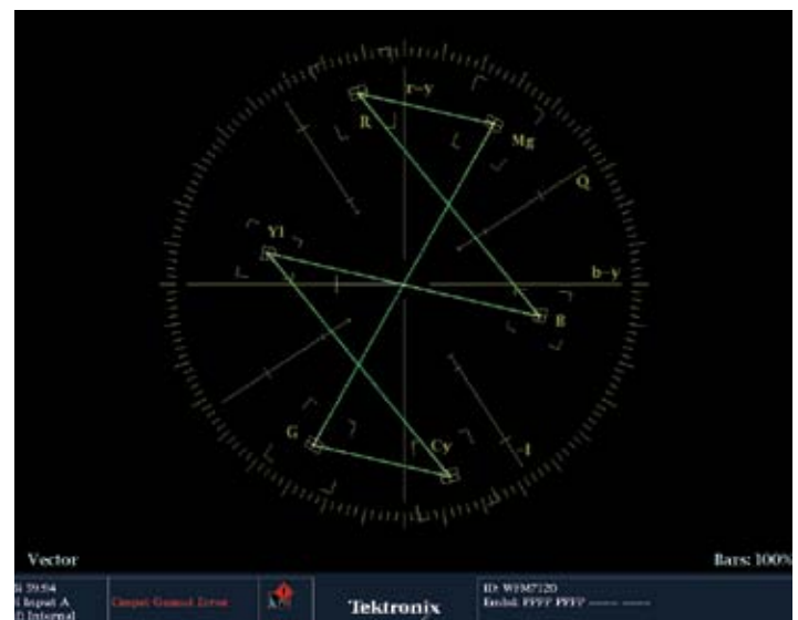
Рис. 99. Окно режима вектороскопа сигнала NTSC
